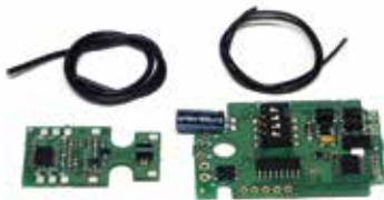
0202a oXigen radio cartridge
